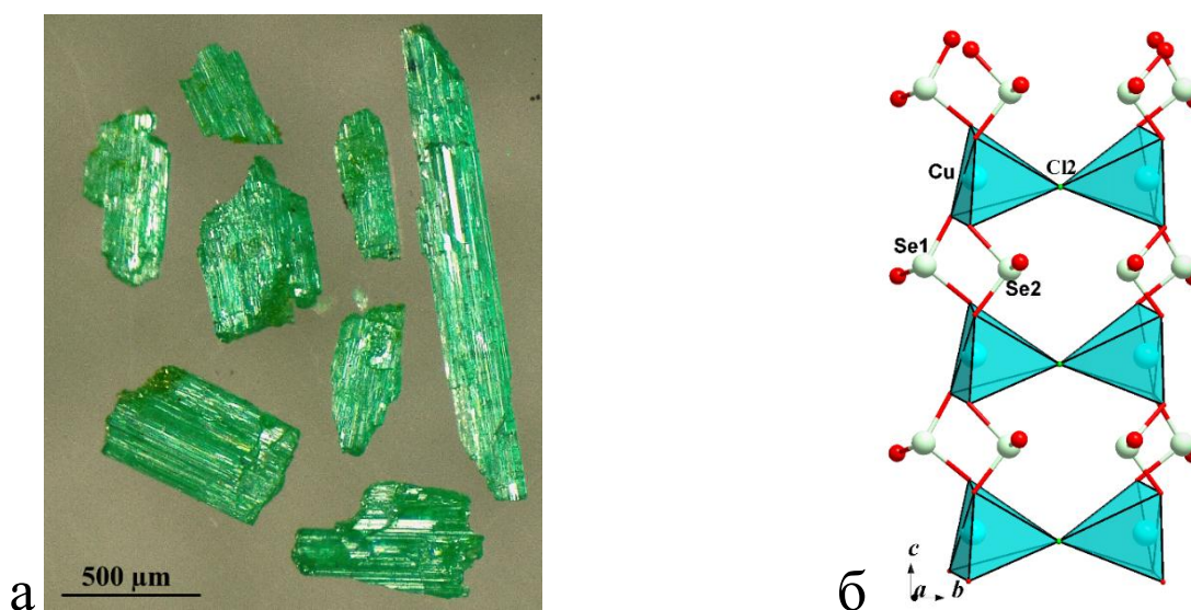
Рис. 1. Фотография призматических кристаллов \text{Pb}_3\text{Cu}_2(\text{SeO}_3)_4\text{Cl}_2 (а) и цепочечный фрагмент их кристаллической структуры [\text{Cu}_2\text{Cl}(\text{SeO}_3)_4]^{5-} (б).
